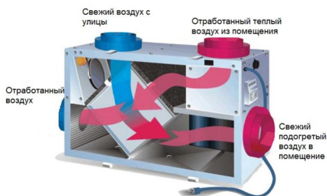
Рис 3. Принцип действия рекуператора.
