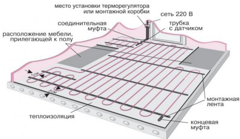
Рис.2 Конструкция электрического «теплого пола»
