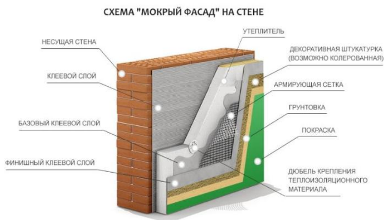
Рис.2 Конструктивная схема «Мокрого фасада»
