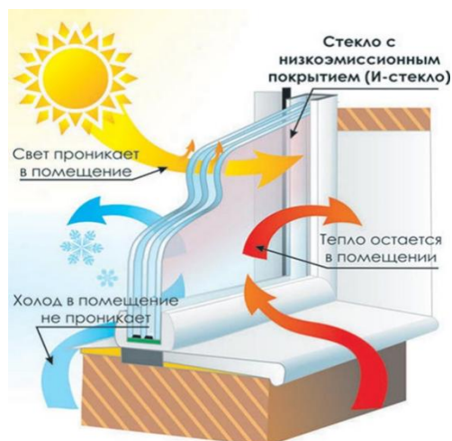
Рис.2 Принцип действия селективного стекла.
